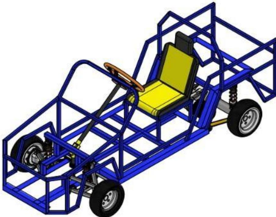
Gambar 2 Bentuk gambar 3D mobil listrik
