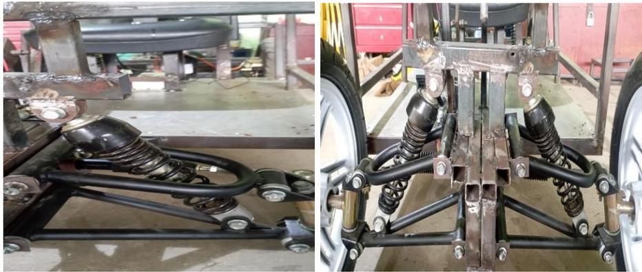
Gambar 7. bentuk landasan suspensi depan
