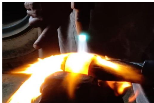
Gambar 2. Pemanasan Ring Penahan Anak Tangga dengan Oxy-asetilin
